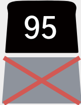
c. 样品座与主机未扣合的情况下，主机电池图标会显示“×”。
